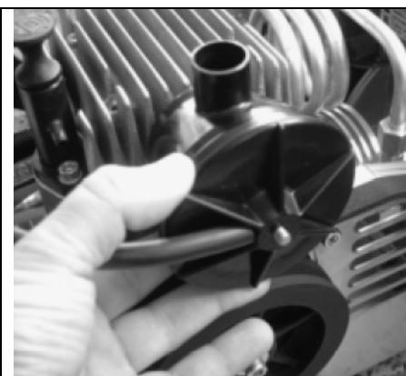
**рис.7: Установите корпус входного фильтра на 1 ступень компрессорной головки, обращая внимание на правильность его положения. (впускной патрубок вертикально вверх, шланг к сапуну слева)**
