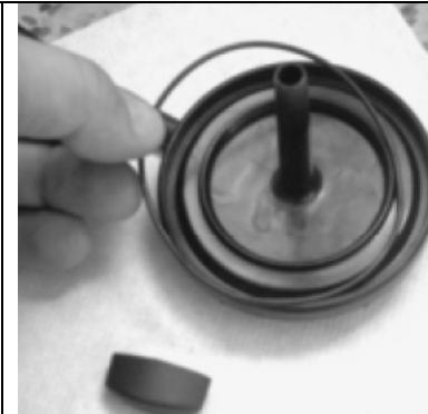
рис.5: Установите уплотнение О-링 в крышку корпуса.
