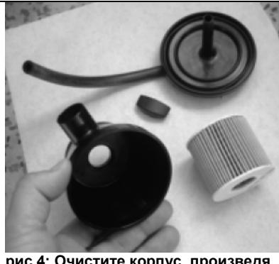
рис.4: Очистите корпус, произведя осмотр на наличие повреждений (трещины и т.п.)
