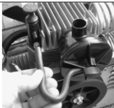
рис.1: Снимите шланг сапуна картера.
