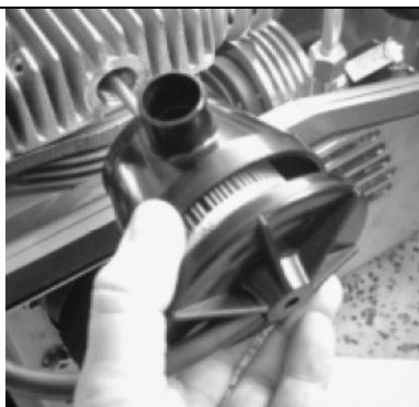
рис.2: Отвинтите барашек и снимите корпус.
