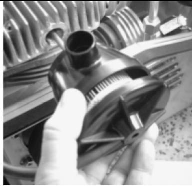
рис.2: Отвинтите барашек и снимите корпус.
