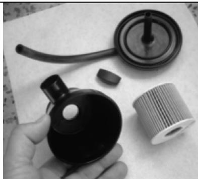
рис.4: Очистите корпус, произведя осмотр на наличие повреждений (трещины и т.п.)
