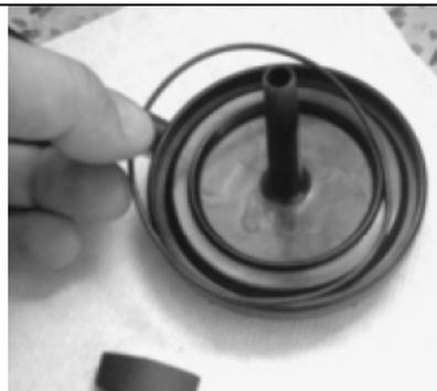
рис.5: Установите уплотнение O-ринг в крышку корпуса.
