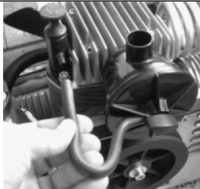
рис.1: Снимите шланг сапуна картера.
