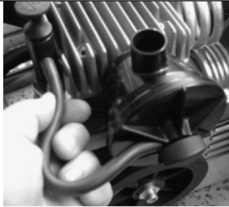
рис.8: Затяните монтажный барашек и заново закрепите шланг сапуна картера к корпусу фильтра и маслосазливной горловине.
