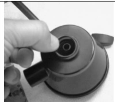
рис.6: Установите картридж на крышку и накройте сверху корпусом. Кольцевое уплотнение установите в соответствующую канавку.
